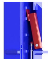
Système de verrouillage automatique
